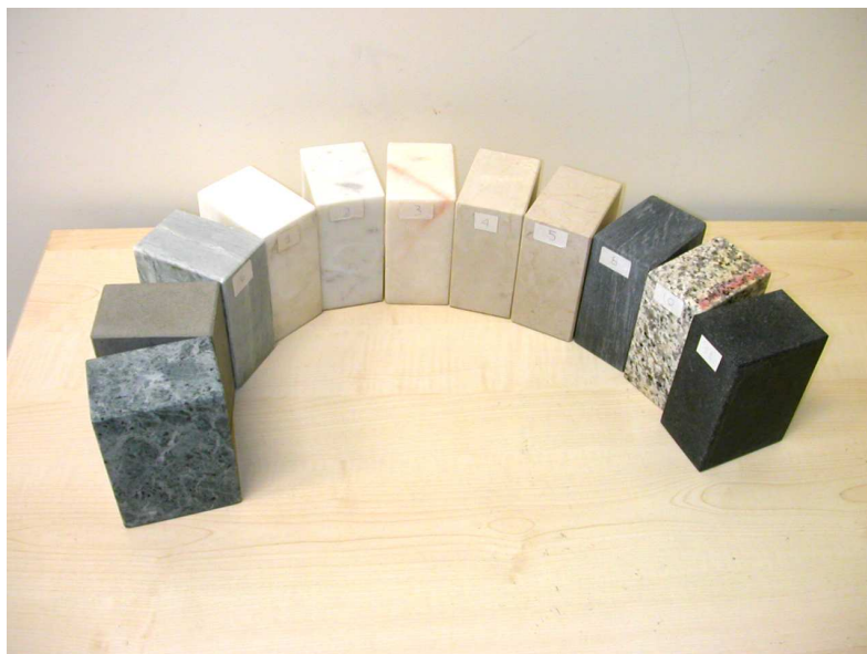
Figura 3. Campioni di materiali lapidei usati per le misure.
