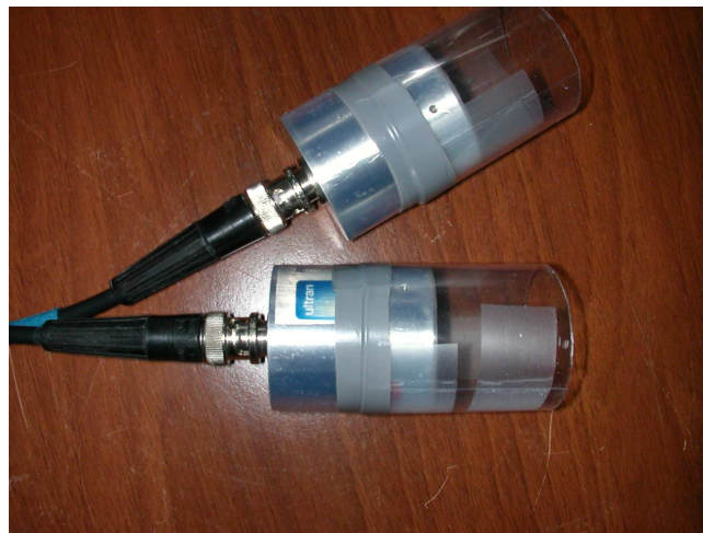
Figura 4. Sonde con distanziatore sagomato di 3 cm.
