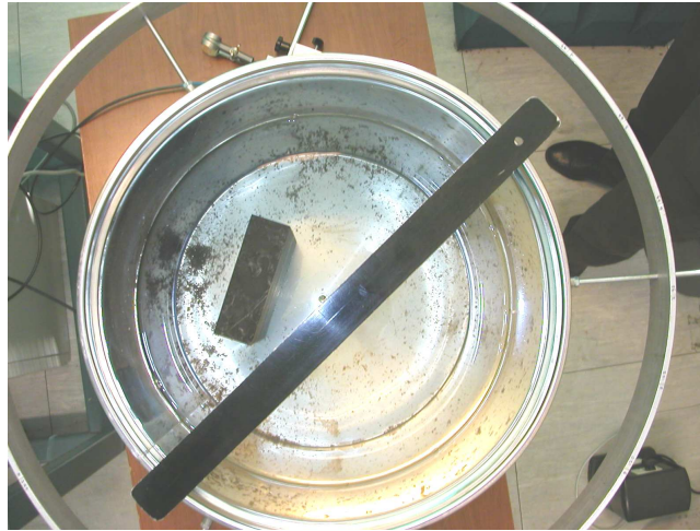
Figura 3. Apparato per la misura in trasmissione attraverso il bidone.
