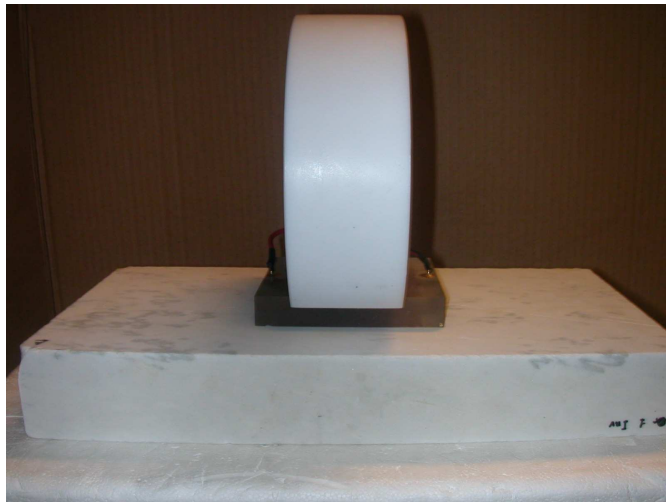
Figura 12. Ispezione mediante il sensore C1. Sul condensatore è appoggiato un peso per ridurre l'aria tra il sensore e la faccia del materiale.
