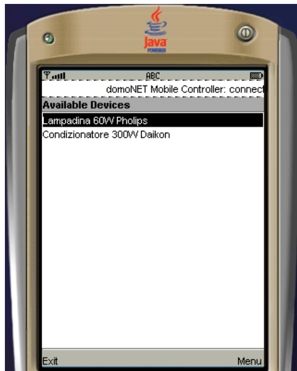
Figura 11: domoNET Mobile Controller visualizza la lista di dispositivi presenti sui Web Services di domoNET.
