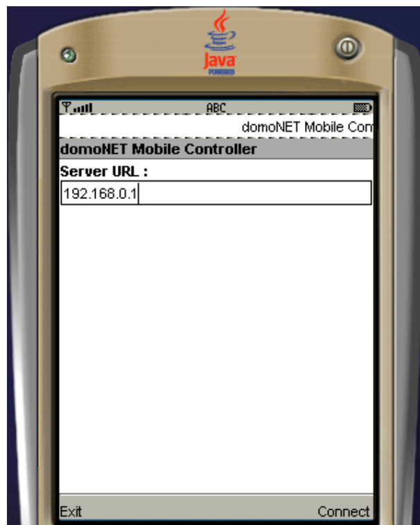
Figura 8: domoNET Mobile Controller in attesa di connettersi a domoNET Mobile Gateway.
