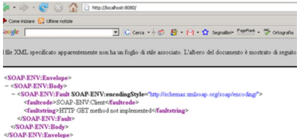
Figura 2.4: Test attraverso il browser di funzionamento del BACnet Web Service.
