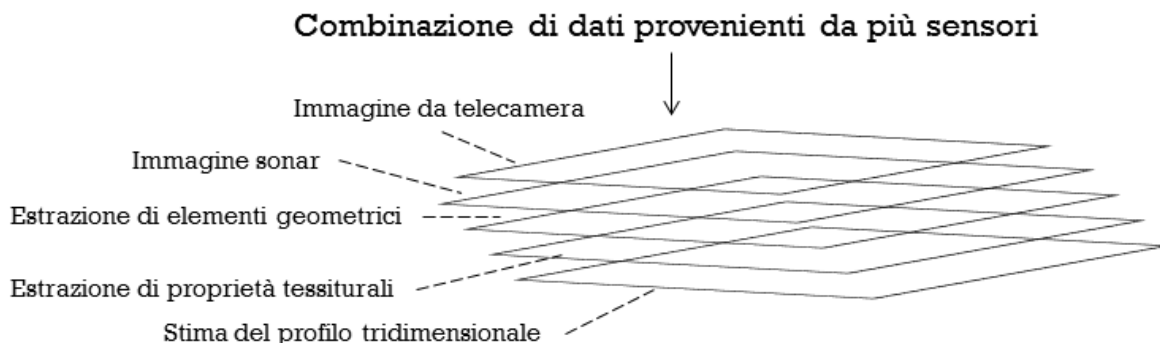
Figura 46 - Schema di rappresentazione dei dati nel modello di fusione
