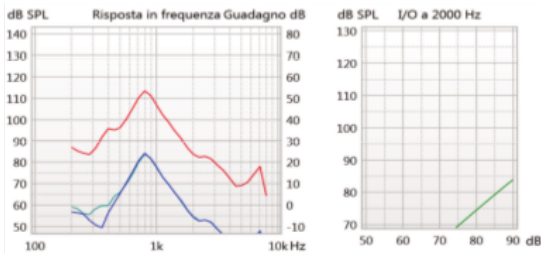
Figura 2 – Curve di risposta per amplificatore endoauricolare.
