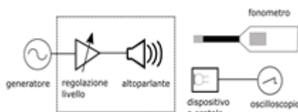
Figura 5 – Set-up per la misura sul dispositivo a scatola
