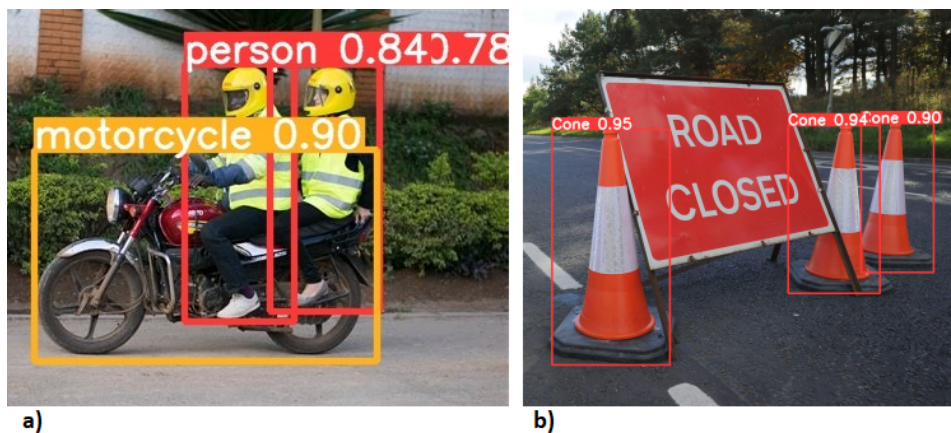
Figura 2: a) Riconoscimento automatico di motocicli, persone e b) coni segnaletici mediante il software open source YOLOv5. L'indicazione della classe di oggetto riconosciuto è sempre collegata ad un valore di confidenza di tale risultato.
