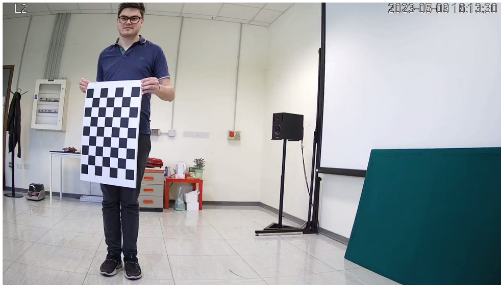
Figure 22: L'immagine insieme ad altre è stata usata per il processo di calibrazione.
