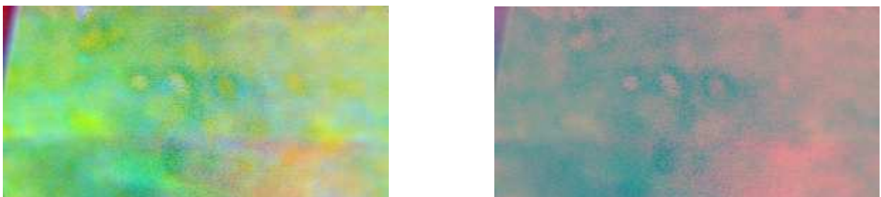
Figura 34. VR3, ROI di apprendimento di dimensioni 136 \times 272 . A sinistra: mappa d'uscita RGB con selezione automatica degli estremi di proiezione ( R = -2.921 \div 2.165 , G = -0.998 \div 0.291 , B = -0.035 \div 0.035 ); a destra: mappa d'uscita RGB con selezione manuale ( R = G = B = -2.921 \div 2.165 ).
