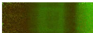
Figura 43. P4. Mappa C-scan dei parametri T_v (rosso), A (verde) e S (blu).
