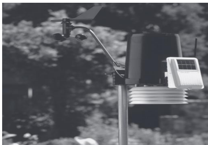
Figura 1: DataLogger, Weather Envoy, Stazione Meteo esterna
