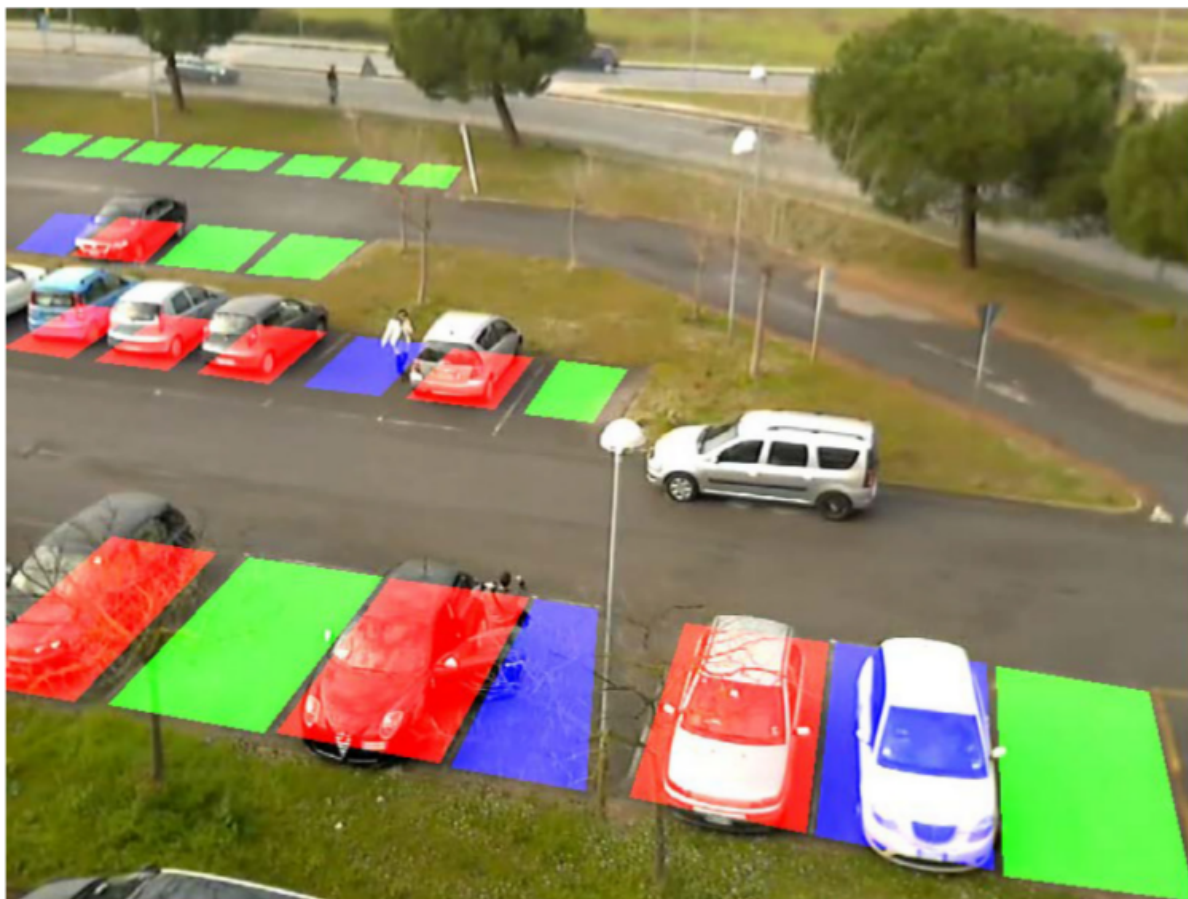
Figura 5 - Lo stato di occupazione degli stalli: verde è disponibile, rosso è occupato e blu incerto (in tal caso si mantiene lo stato precedente)
