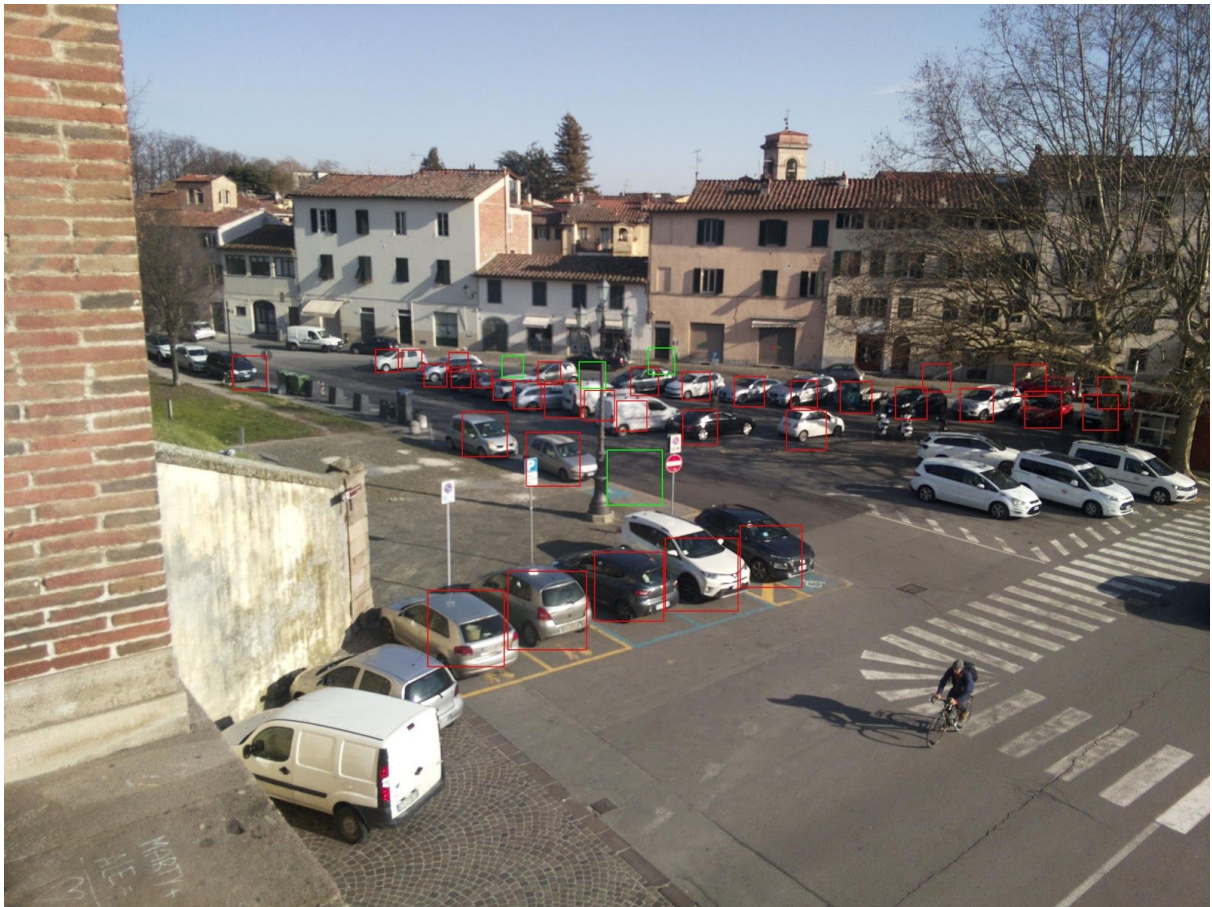
Fig. 6b - Esempio di classificazione dei singoli stalli per la camera 2
