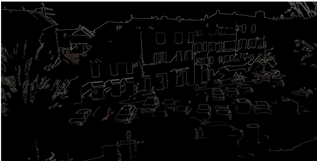
Fig. 9 - Il rilevamento dei bordi (edge-detection) è una elaborazione che permette di ottenere informazioni utili per determinare la presenza di elementi in una zona dell'immagine.
