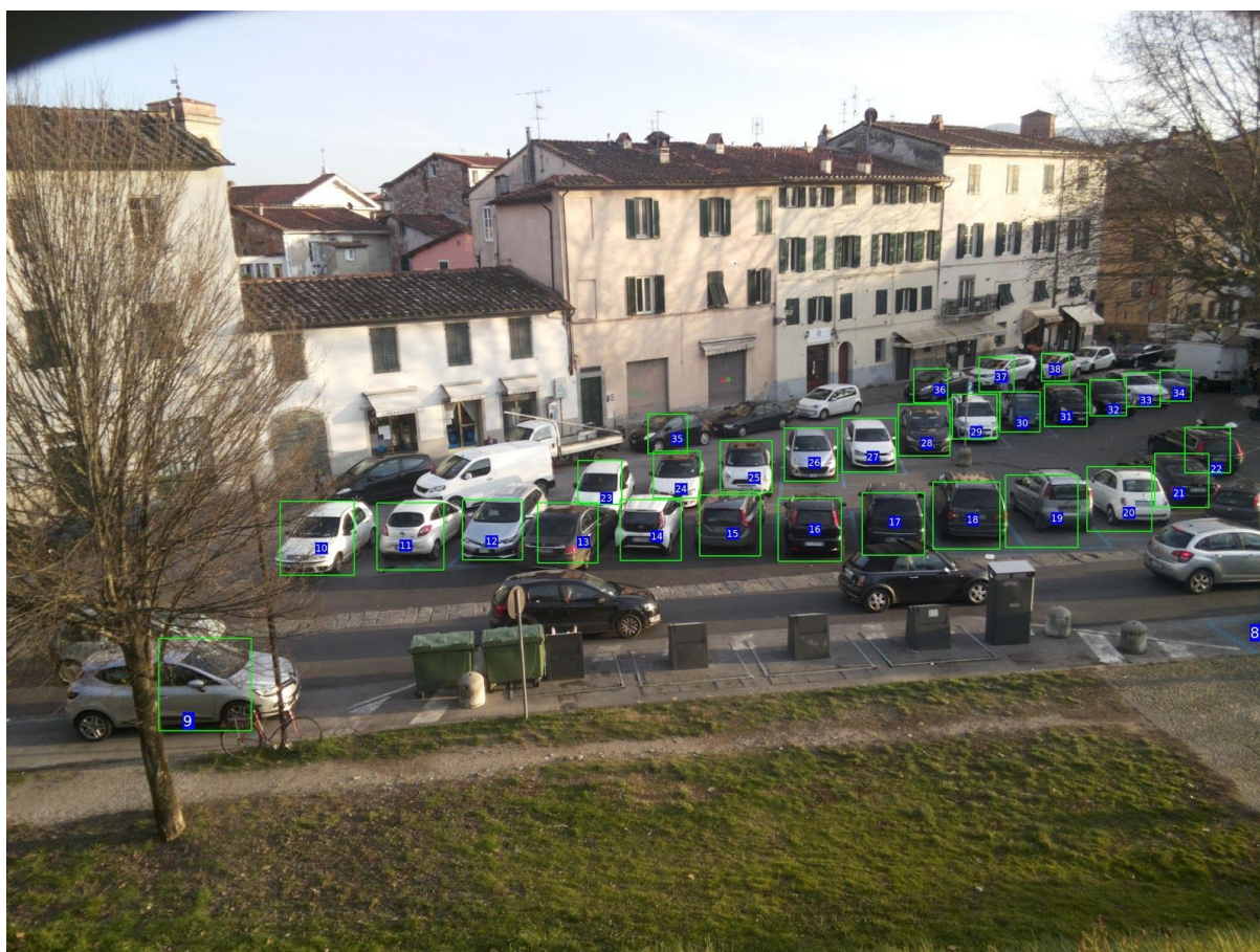
Fig. 4a - Maschere dei singoli stalli della camera 1
