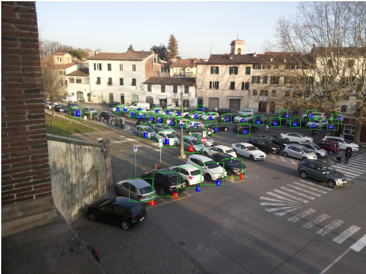
Fig. 4b - Maschere dei singoli stalli della camera 2
