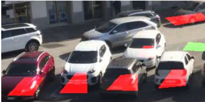
Fig. 8a Le ROI sono disegnate per ridurre le occlusioni
