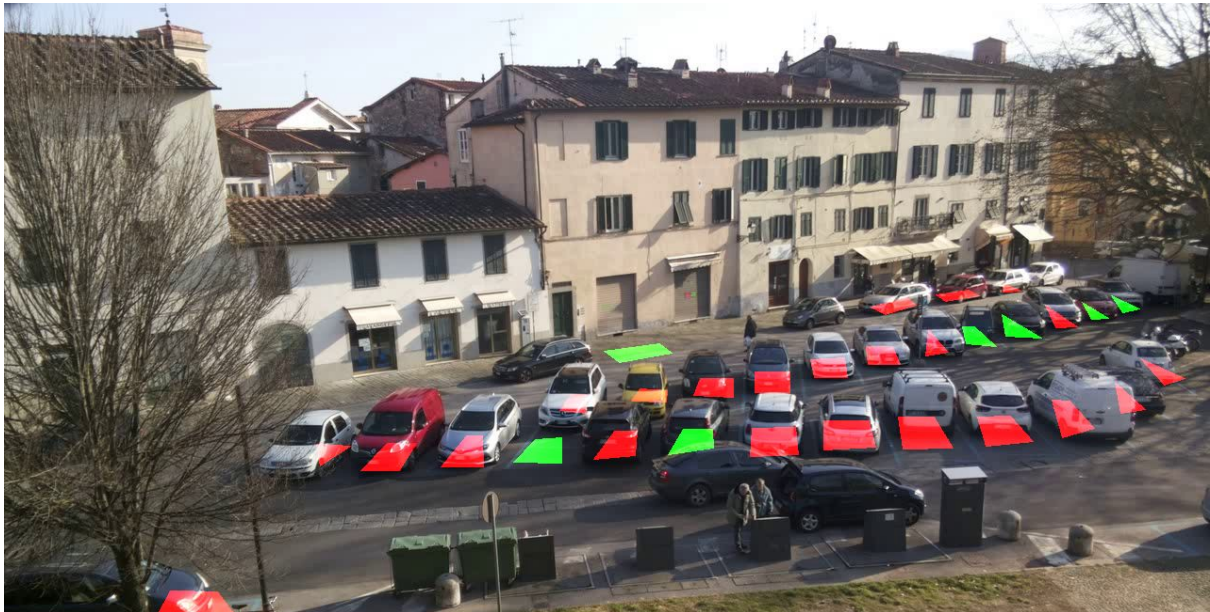
Fig. 11a - Le embedded camera lavorano con immagini a risoluzione medio-bassa e l'accuratezza scende molto al crescere della distanza dal sensore.
