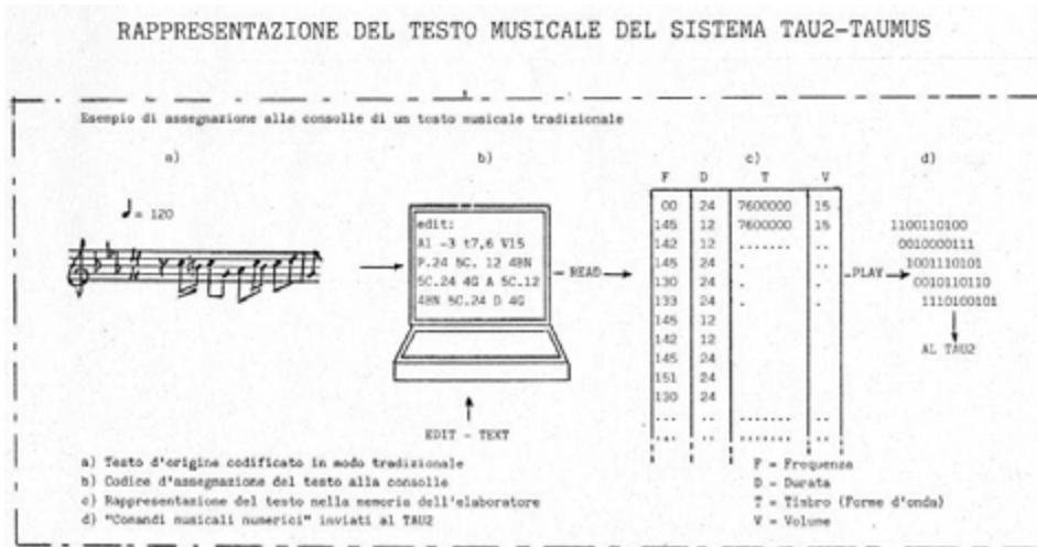
Figura 5 – Livelli di codifica del testo musicale: a) pentagramma, b) alla console; c) area di lavoro, d) codici inviati al TAU2.
