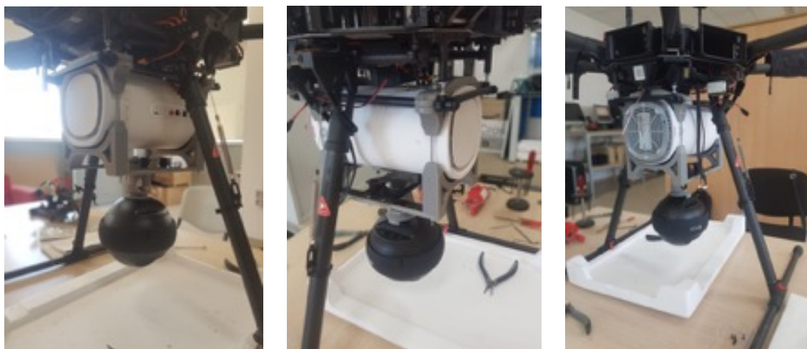
Figura 2: Il modem 5G alloggiato a bordo drone insieme alla telecamera 360
