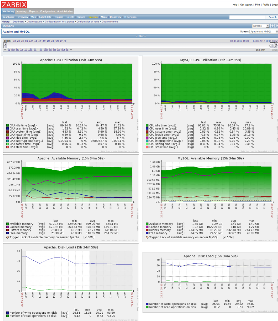
Figura 4: Esempio di grafici prodotti con Zabbix per il monitoraggio dei server Apache e MySQL
