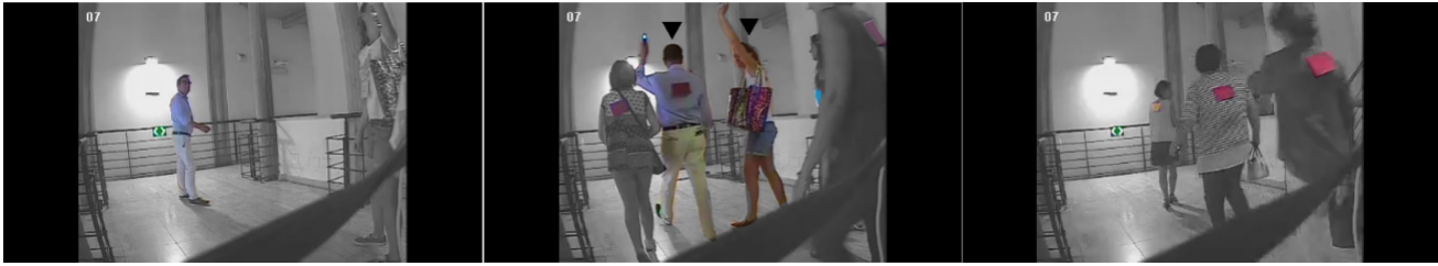
Figura 13. Prova con sistema di gestione (prova dinamica): il capogruppo del gruppo 1 attende i suoi familiari (sinistra); i gruppi 1 e 2 si incrociano mantenendosi compatti quanto più possibile secondo il fenomeno di attaccamento al leader (centro); le persone del gruppo 1 seguono i compagni (destra).
