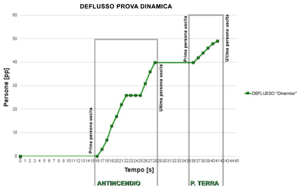
Figura 14. Evacuazione con sistema di gestione: influenza del percorso (e dell'uscita) sulla curva di esodo. Le uscite antincendio ( U_A in Figura 12) e dal piano terra di Villarey sono distinte nelle loro curve relative identificando primo e ultimo uscito. La differenziazione risulta netta a causa della lunghezza dei percorsi.
