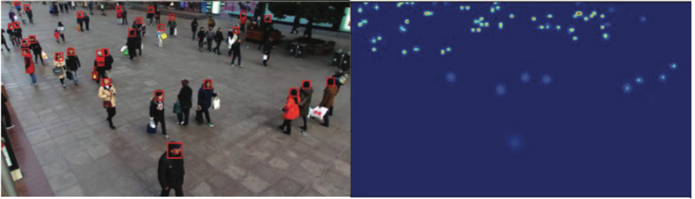
Confronto tra tecniche per il conteggio di persone. Sinistra: Basato su Face Detection. Destra: Mappa di densità
